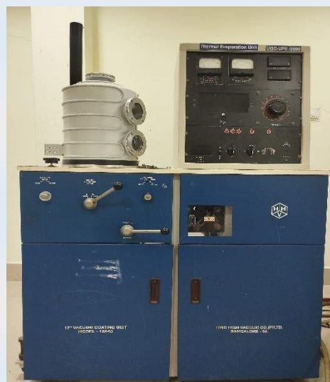
Thermal Vapor Deposition
